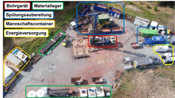
Abbildung 2: Drohnenaufnahme des Bohrplatzes während der Bohrphase.
