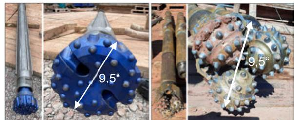
Abbildung 3: Wasserhammer (links). Rollenmeißel mit Stabilizer (rechts).
