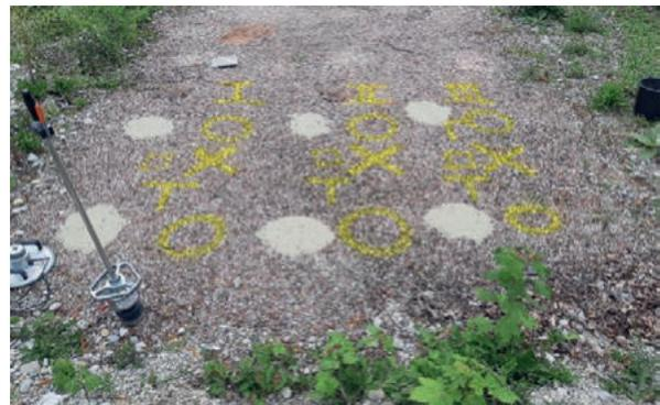
Abbildung 4-5: Gestörte Oberfläche des eingebauten ZFSV 612 Tage nach Einbau
