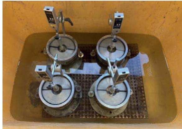
Abbildung 3-1: Proben aus ZFSV während der Wasserlagerung
