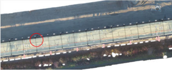
Abbildung 2-14: Überlagerung Befliegung und Planung Soll-Ist-Vergleich
