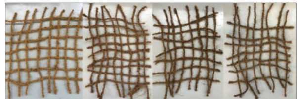
Abbildung 4-3: GTX-W1 vor dem Einbau und nach 2, 4, 11 Wochen (Dziemba, 2019)
