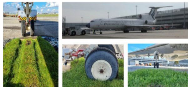
Abbildung 6-2: Überfahrversuche Testfeld am Stuttgarter Flughafen mit einer Tupolew Tu-154
