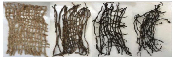
Abbildung 4-4: GTX-W2 vor dem Einbau und nach 2, 4, 11 Wochen (Dziemba, 2019)
