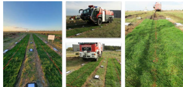
Abbildung 6-1: Überfahrversuche Testfeld am Braunschweiger Flughafen mit der Flughafenfeuerwehr
