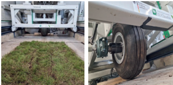
Abbildung 1-3: Überfahrversuchsstand mit Bugrad eines A320 und Einbau eines begrünten Streifens
