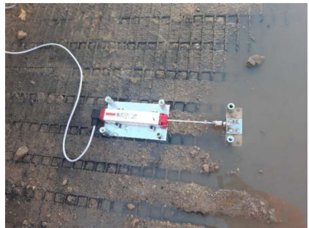
Abbildung 9: Auf Geogitter fixierter Wegaufnehmer.
