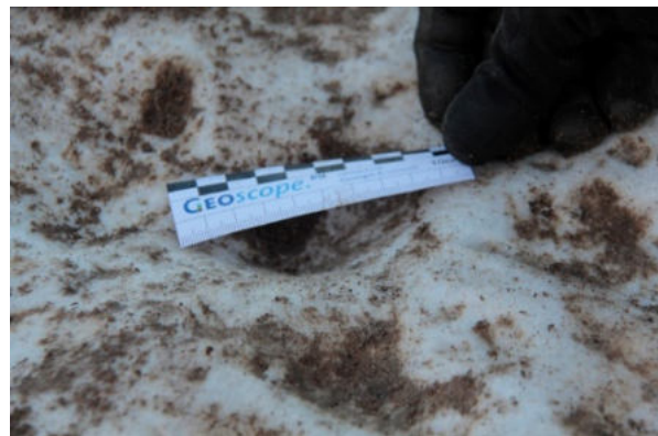
Abbildung 3-3: Beschädigte Probe eines thermisch unbehandelten GTX-NW
