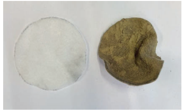
Abbildung 7: Geotextiler Vliesstoff nach innerer Erosion der Bodenprobe (Piping) mit UL.
