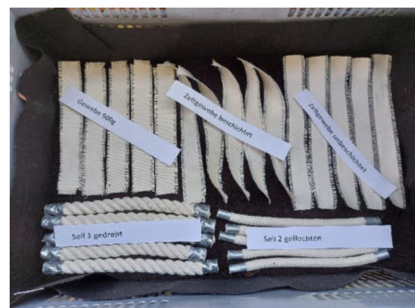
Abbildung 4-2: Verschiedene Referenzproben aus Baumwolle
