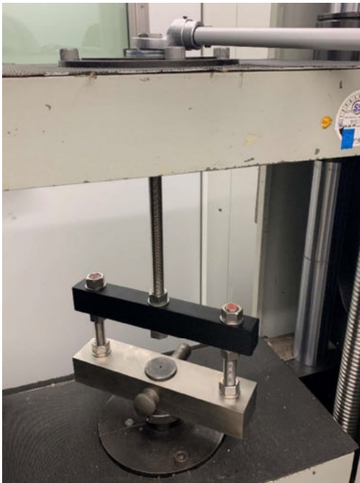
Abbildung 7: Versuchsaufbau für die Bestimmung des Anzugsmomentes der Zugstangen.
