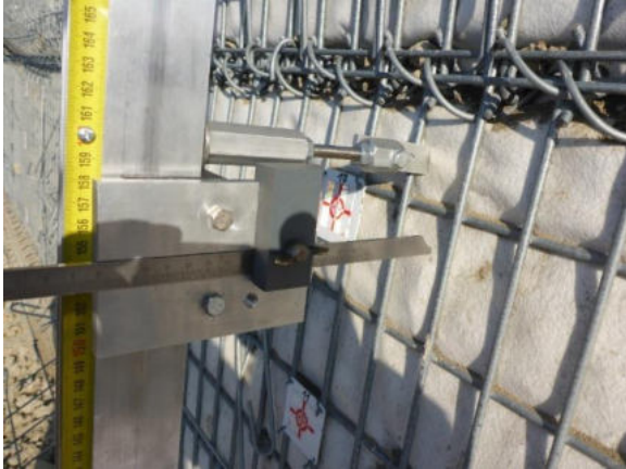
Abbildung 7: Messeinrichtung zur Kontrolle der Ausbauchung
