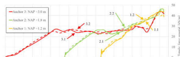
Abbildung 8: Numerisch ermittelte Zugkräfte in den Ankerlagen. Gestrichelte Linie: oberes Geogitter, durchgezogene Linie: unteres Geogitter.
