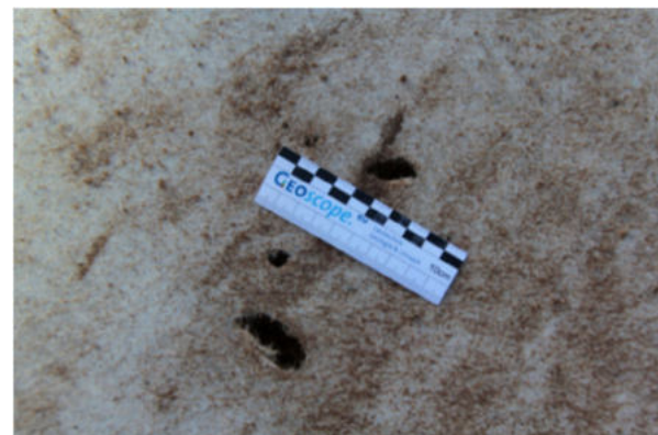
Abbildung 3-4: Beschädigte Probe eines thermisch nachbehandelten GTX-NW
