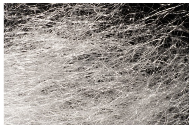
Abbildung 3-1: Stapelfaser G1 als Rohstoff für das zu 100-prozent biologisch abbaubare Geotextil Secutex® Green
