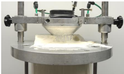
Abbildung 2: Ausstechvorrichtung zur Gewinnung einer Probe aus einer vorkonsolidierten Kaolinmasse unter Verwendung einer Gummihülle aus Butyl.
