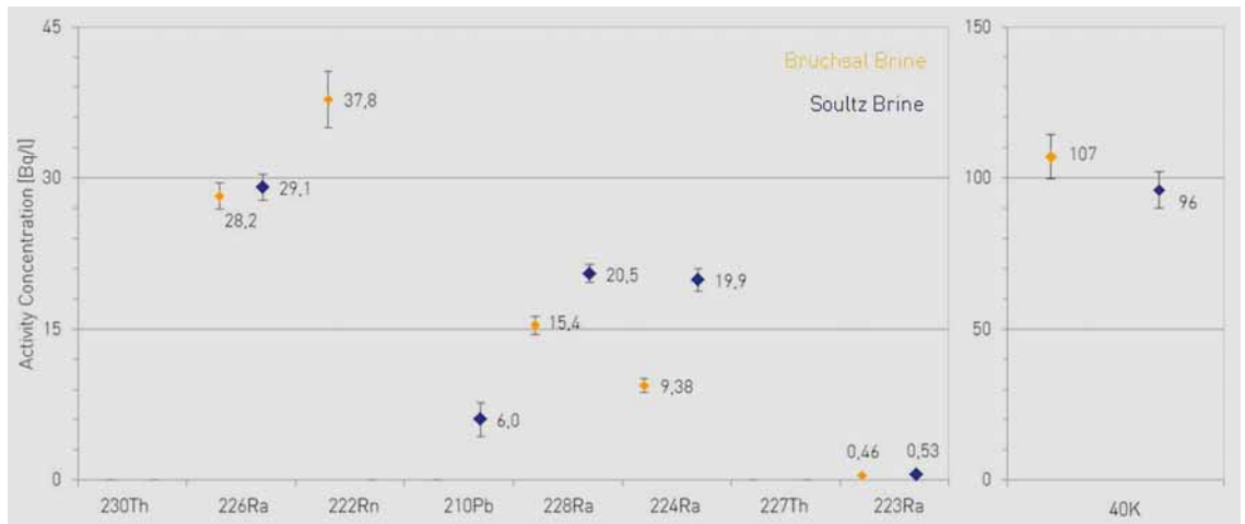
Bild 6. Aktivitätskonzentrationen der untersuchten Radionuklide der ^{238}\text{U} , ^{235}\text{U} und ^{232}\text{Th} -Zerfallsreihe der Tiefenwässer aus Bruchsal und Soultz-sous-Forêts.
