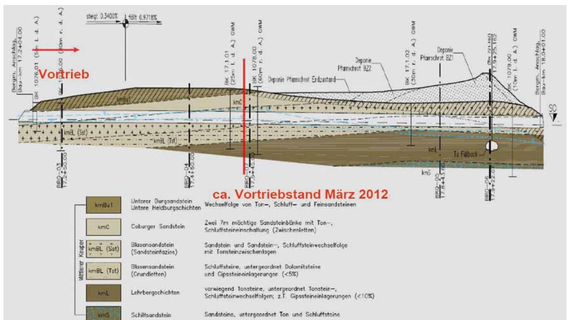
Bild 3. Geologischer Längsschnitt des Tunnels Höhnberg.
