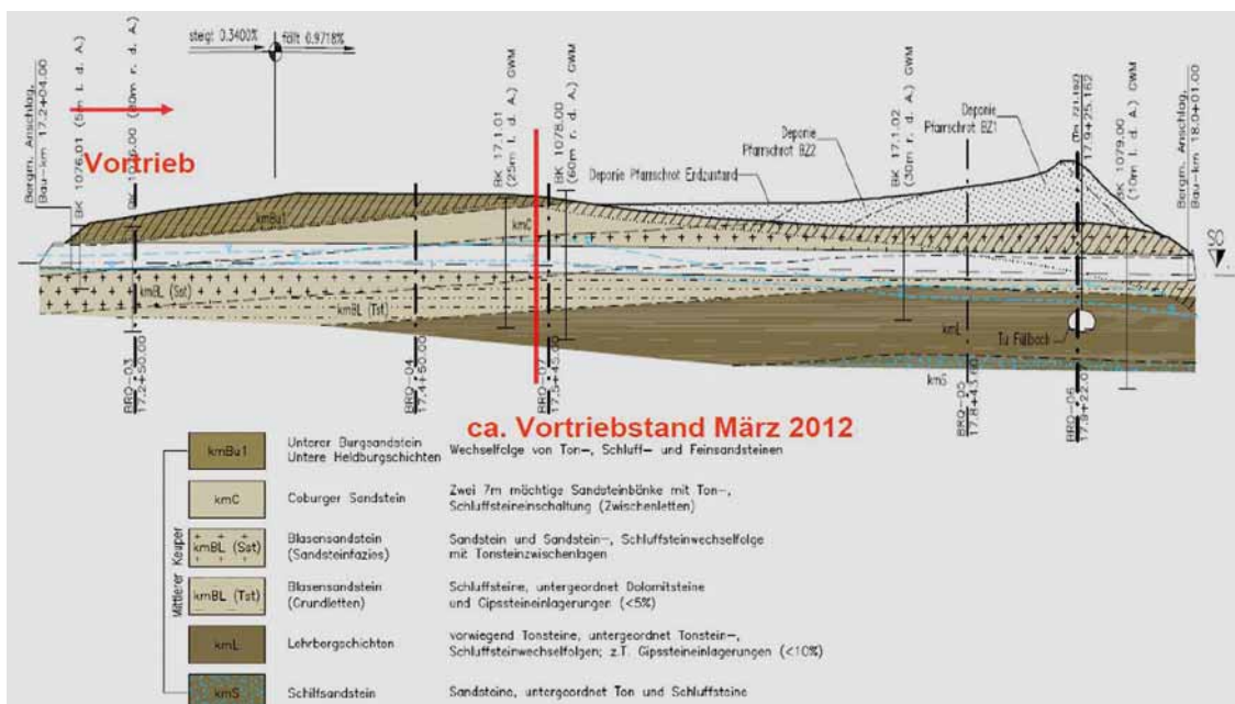
Bild 3. Geologischer Längsschnitt des Tunnels Höhnberg.
