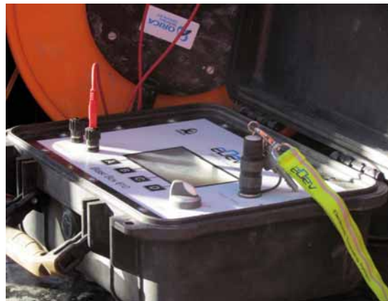
Bild 4. Auslösung der Sprengung mithilfe der Sprengbox.
